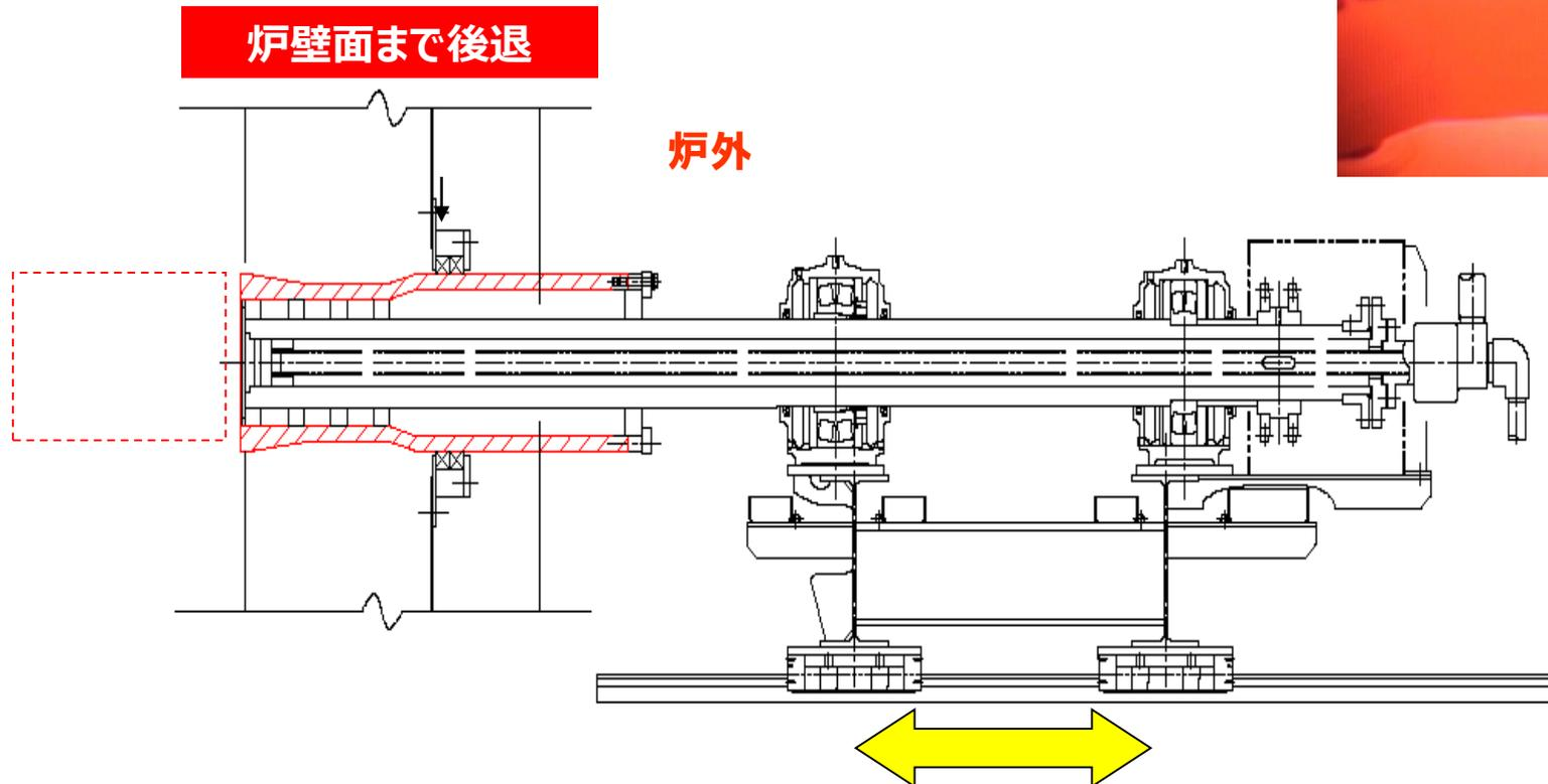
ワイヤードブランケットの無水化(炉内スキッドビーム、ポスト断熱強化)・・・連続加熱炉
