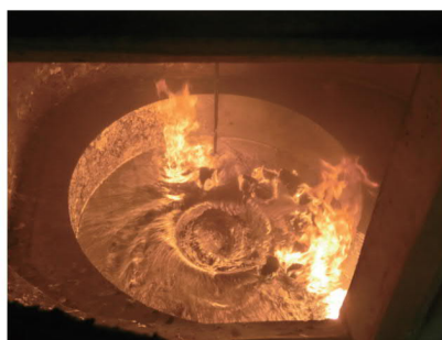
ブリケット溶解室状況
