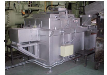
アンダーヒート式保持炉
