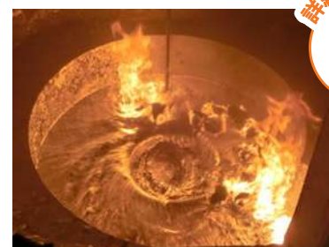
アルミ切粉リサイクル ブリケット溶解システム
